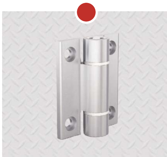
Charnière à ressort en profil aluminium anodisée incolore (existe en 0,35 N.m, 0,70 N.m et 1,3 N.m)
